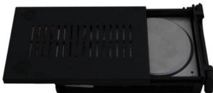
3 - Si un disque dur est déjà en place, dévissez les 4 vis qui le fixe. Soulevez le disque doucement puis déconnectez la nappe IDE et le connecteur d'alimentation. Ne soyez pas brutal.
