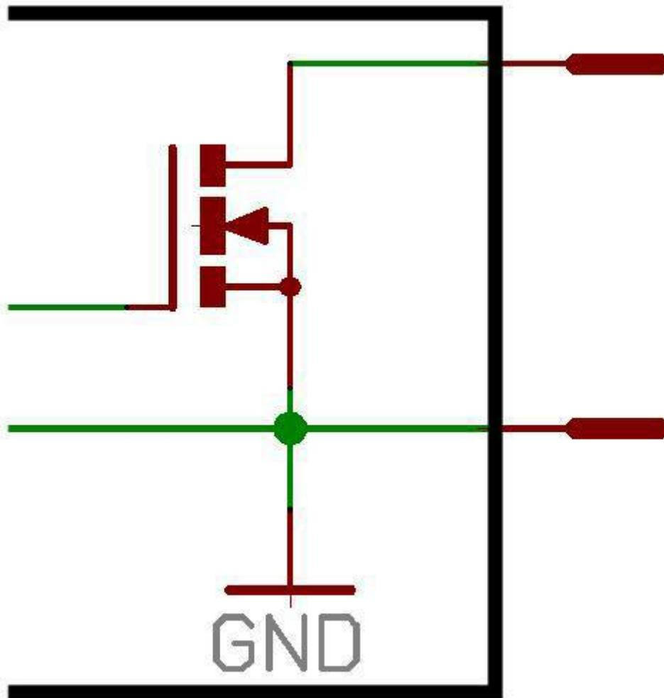
Schéma d'une sortie.
